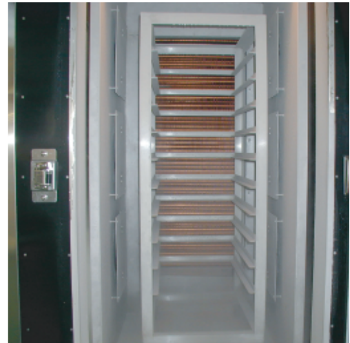
■ラック部（写真奥は冷却機）
